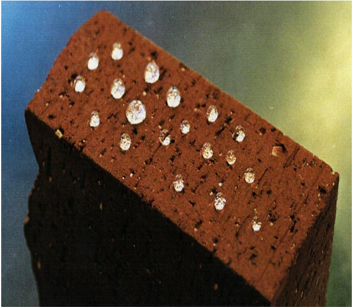
Bild. 11. impregnerat tegel. ( Nsiab, 2010 )
